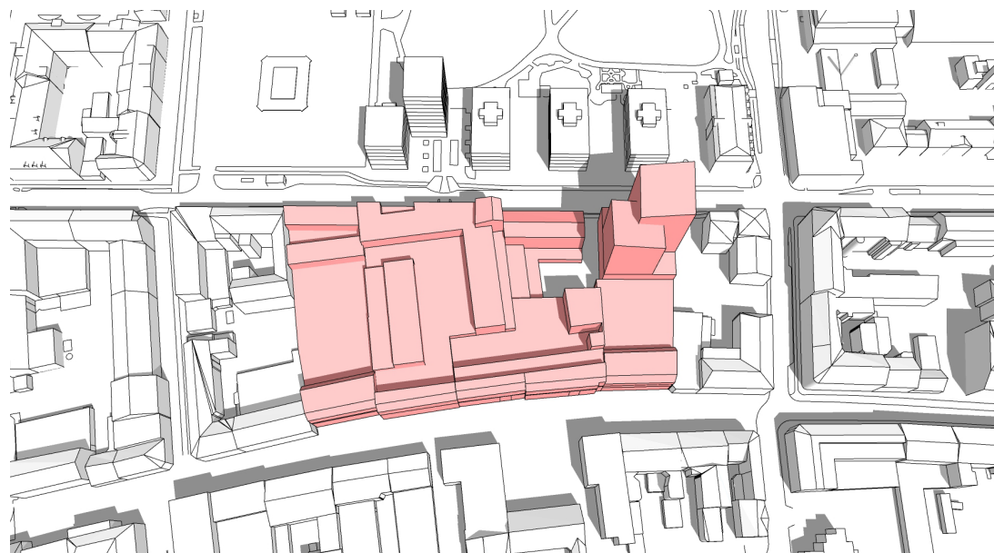
Vandrande skugga från höghuset som projiceras på motstående fasad kv Bävern. Skuggans uppehållstid är ca 2-3 tim/ lägenhet på samtliga våningsplan vända mot söder. - avser mitten av juni kl 12:00
