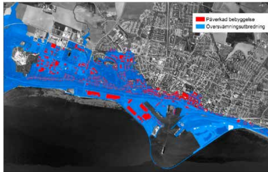
Översvämningsutbredning vid havsvattenstånd +3,35 m (relativt RH2000) visas i blått. Påverkade byggnader är markerade i rött.
