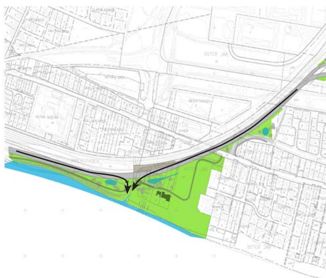
Principen för dagvattenhantering - normal/skyfall gällande planområdets södra del - Hammleden samt Östra stranden
