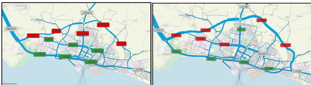
Figur 6.24. Trafikprognos (flödeskarta) för Östra ringvägen samt övrigt vägnät i Trelleborg för år 2040. Vänstra figuren visar en situation där hamnfarten fortsatt är i väst, ökat trafikflöde visas i rött och minskat trafikflöde i grönt jämfört med nollalternativet. Den högra figuren visar en situation där hamnfart sker från öst. Siffror är i förhållande till den vänstra figuren. Figuren är framtagen av Ramböll.
