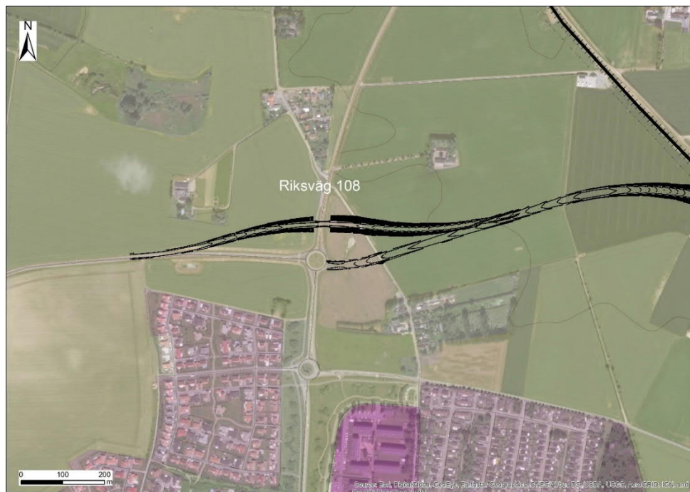
Figur 6.9. Karta över Östra ringvägens korsning med väg 108 i alternativet som utgörs av enfiligt expressfält, här i varianten med expressfältet i undergång under väg 108, samt anslutning av ringvägen till cirkulationsplatsen. Även expressfält där ringvägen leds över väg 108 via en övergång har utretts, men är inte illustrerad i denna figur men skiljer sig inte mycket från alternativet i figuren.
