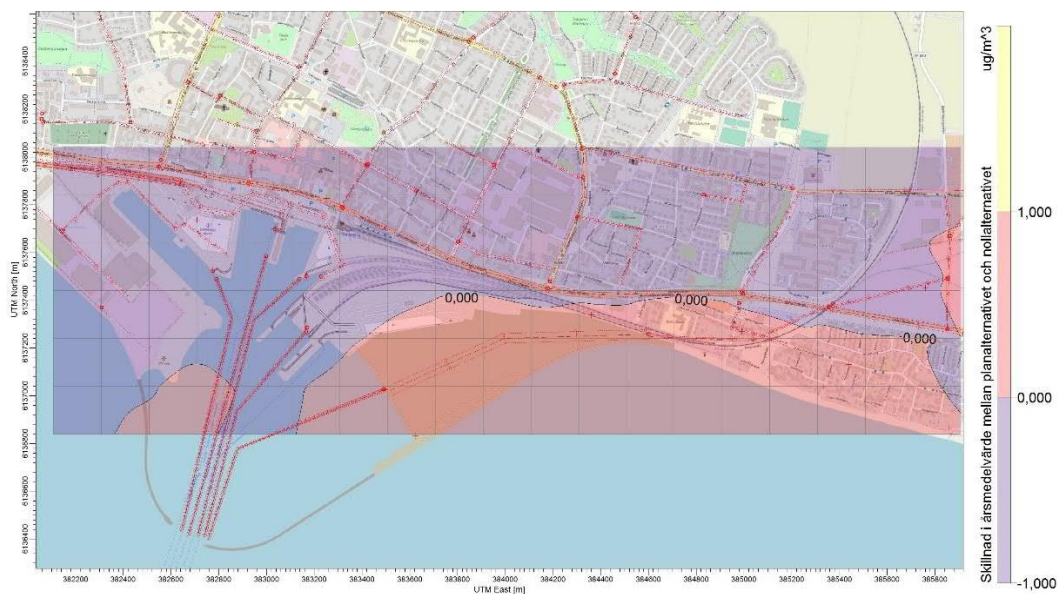
Figur 7.58. Spridningskarta som visar skillnaden av PM 10 mellan detaljplaner och nollalternativ. Blå ytor visar en minskning av halterna i planalternativet och röda ytor visar en ökning av halterna. Skillnaden mellan alternativen är < 1 \mu\text{g}/\text{m}^3 .
