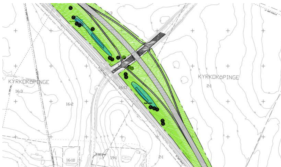
Figur 8.3. Illustration av Östra ringvägens korsning med Gyllevägen. Figuren visar exempel på dagvattenlösningar längs sträckan.
