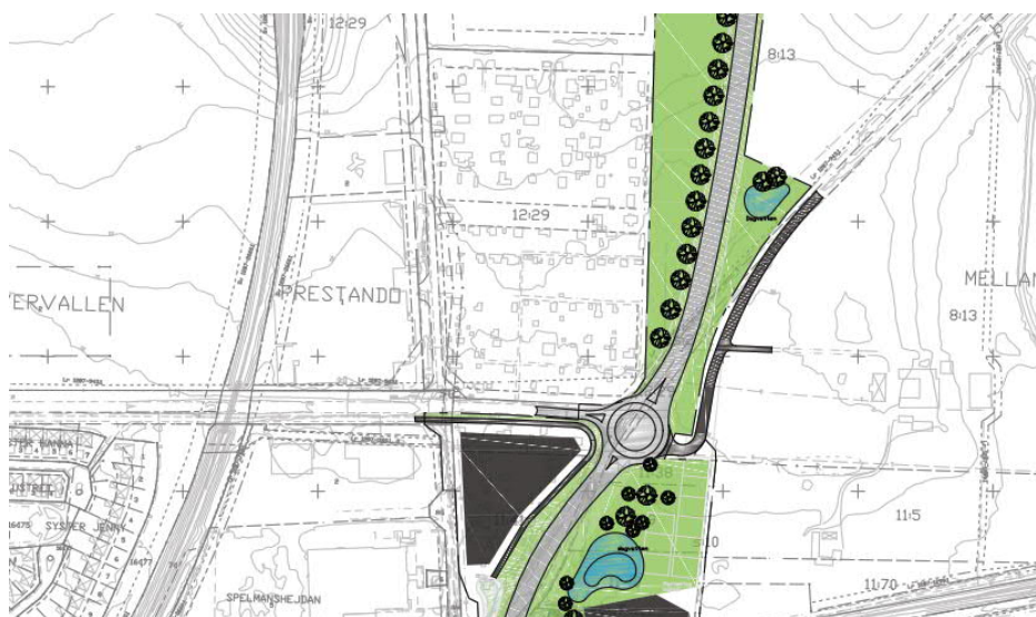
Figur 6.19. Illustration av korsningen mellan Östra ringvägen och Engelbrektsgatan/Dalköpinge byaväg enligt alternativet cirkulationsplats.
