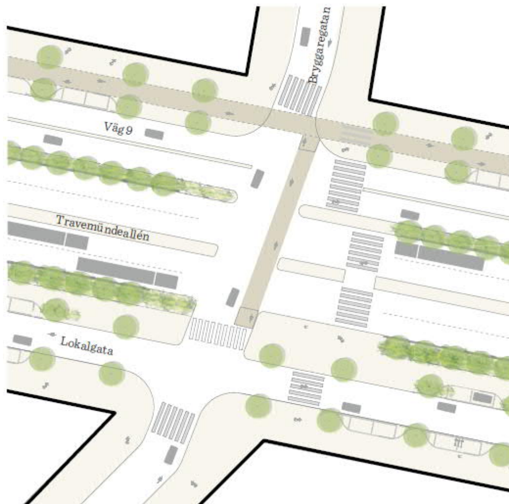
Figur 6.6. Principskiss som visar förslag på boulevardens utformning (Spacescape & Iterio, 2019).
