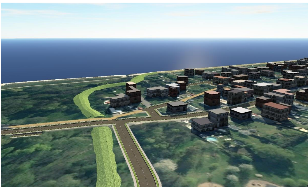
Figur 6-4 Visualisering av en vall längs Dalköpingeån. Vallen som visas i visualiseringen har en krönnivå på 3,0, ett 3 m brett vallkrön och släntlutning 1:3.
