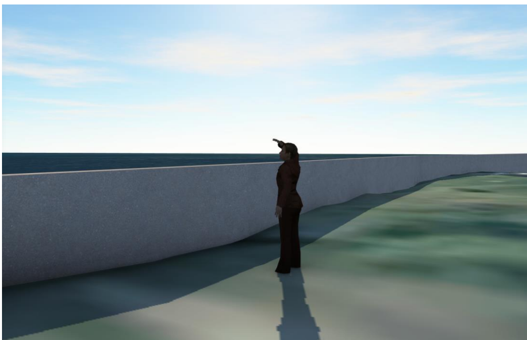
Figur 4-4 Visualisering av föreslagen översvämningsmur och vall i Skåre. Skyddet som visas har en krönnivå på +3,0 m. Övre bilden visar en översikt över området, nedre bilden visar en detaljvy över skyddet och hur det kan komma att upplevas, personens position har markerats med röd cirkel i den övre figuren.
